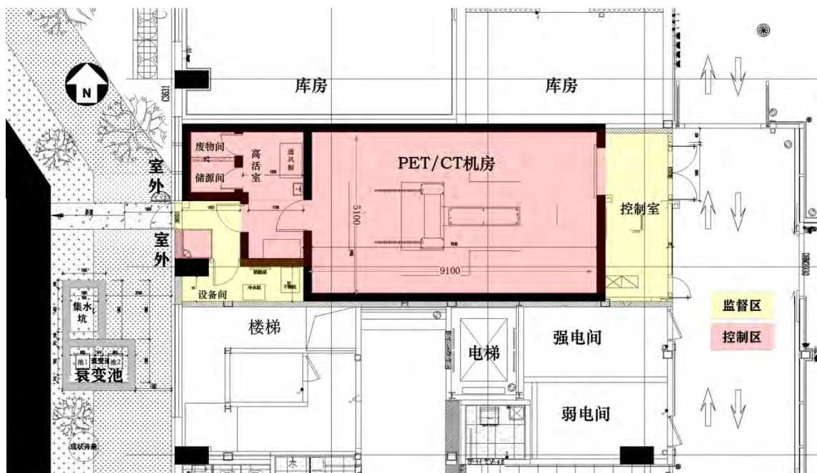
图 9-1 PET/CT 调试场所平面布局示意图
